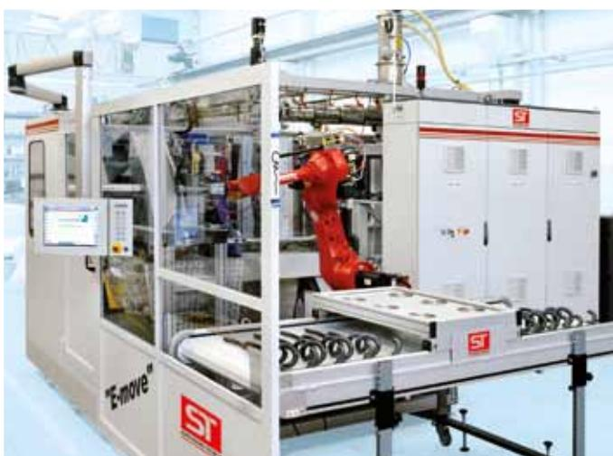
Die **ASPI e-move** ist eine vollelektrische Suglasmaschine für **MONO**-Anwendungen. Sie ist für Artikel von kleinem bis mittleren Durchmesser ausgelegt, die aber durch eine grössere Länge und erhöhte Komplexität gekennzeichnet sind.
